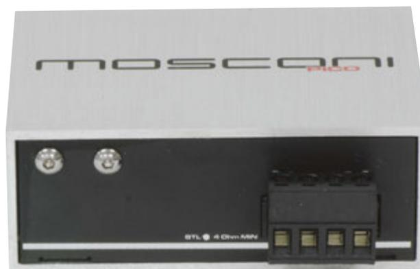
I due lati del Pico 2. Impossibile "infilare" tutte le connessioni su un solo. Dunque è stato spostato il connettore dedicato al collegamento con gli altoparlanti mantenendo sul lato opposto tutte le altre connessioni e controlli.
