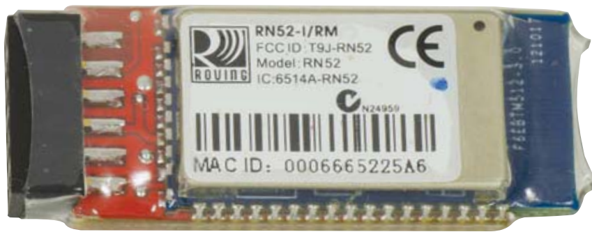
Il piccolo modulo Bluetooth che permette lo streaming di formati musicali anche evoluti.
