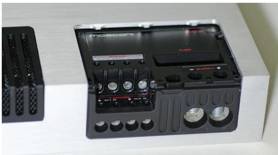
Le connessioni di potenza, altoparlanti ed alimentazione sono concentrate nella "finestrella" di destra. Qui si accede anche al fusibile di bordo.
