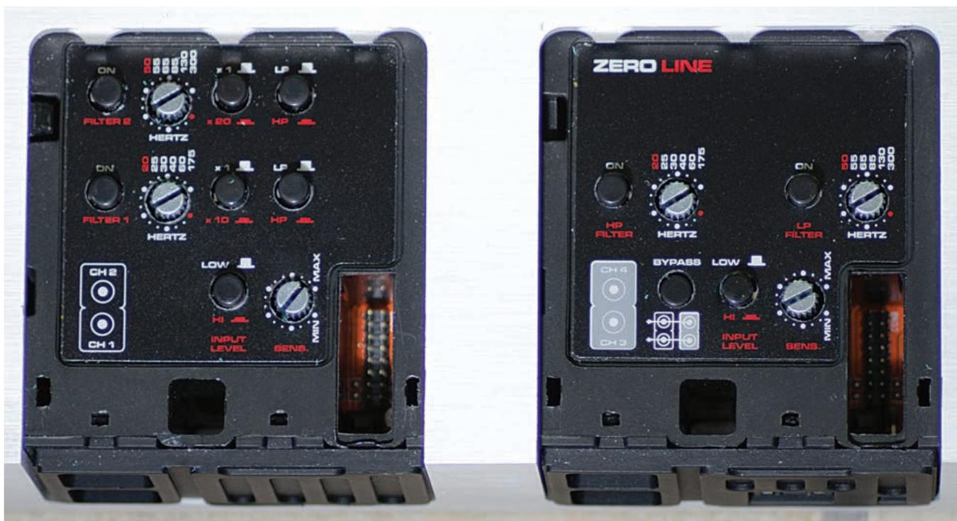
Le due "finestre" destinate alle connessioni ed ai controlli del segnale d'ingresso. Quella più a sinistra è dedicata ai canali di minor potenza e vanta la priorità degli ingressi ed un crossover più flessibile. A destra, quella per i canali di maggior potenza, crossover passa-banda e ingressi che possono divenire uscite di servizio per altri finali.
