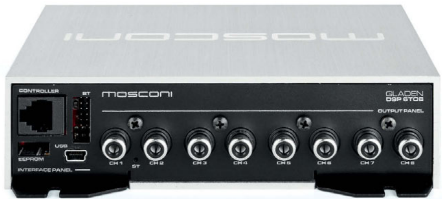
Il lato delle uscite. Sulla parte sinistra ci sono i connettori per l'inserimento delle due schede opzionali visibili nella foto di apertura: il Bluetooth e la EEPROM da utilizzare per non sovrascrivere la memoria interna.
