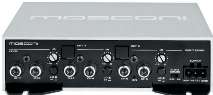
Il lato degli ingressi. Da notare le due predisposizioni per gli ingressi ottici digitali opzionali ed i potenziometri per la regolazione del livello in ingresso che hanno le serigrafie in dB.
